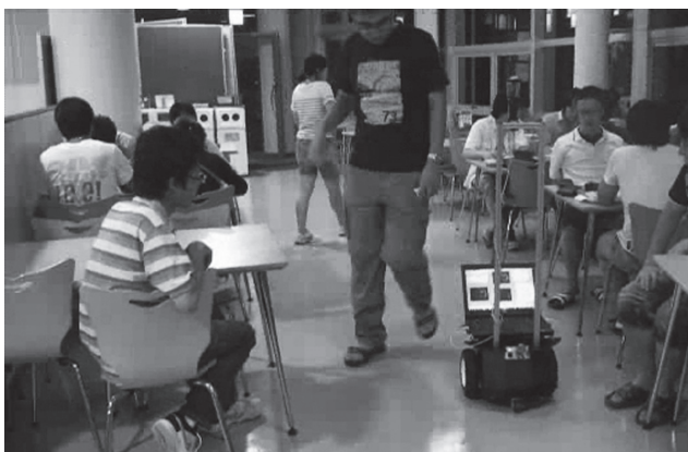
第13図 ナビゲーションフェーズでのロボットの稼働の様子。混雑した環境下でも自律的にゴールに向かって移動している。
